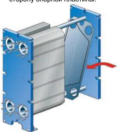
Стяните набор пластин. Затягивайте в два этапа (см. рисунки ниже). Следите за тем, чтобы опорная и прижимная пластина постоянно были параллельны друг другу.
